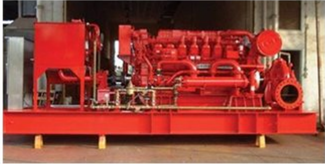
Yangın su pompası
