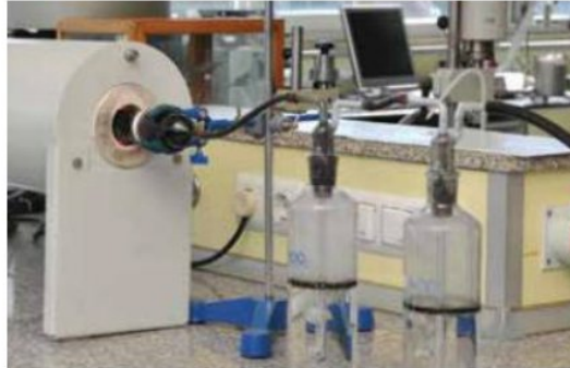
IEC60754-1/2 yanma sonrası açığa çıkan gazların su içinde biriktirilmesi, pH ve iletkenlik ölçümü
