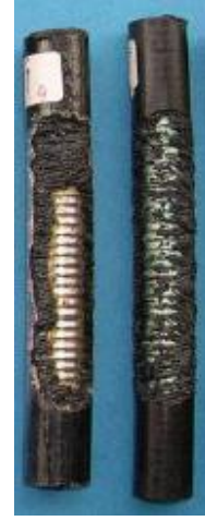
Resim 3: Kemirgen saldırısına maruz kalan zırlı fiber optik kablo
