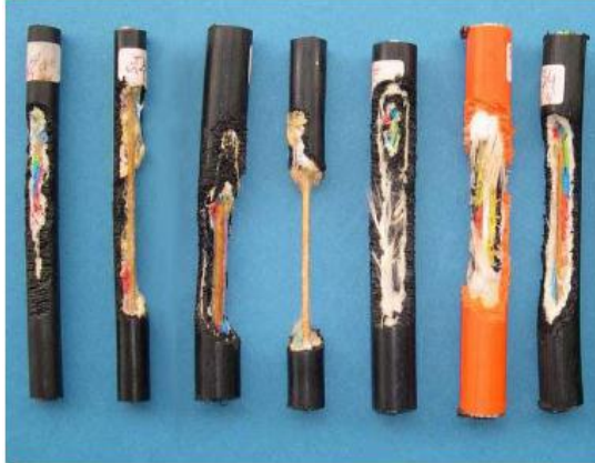
Resim 1: Kemirgen saldırısına uğramış kablolar
