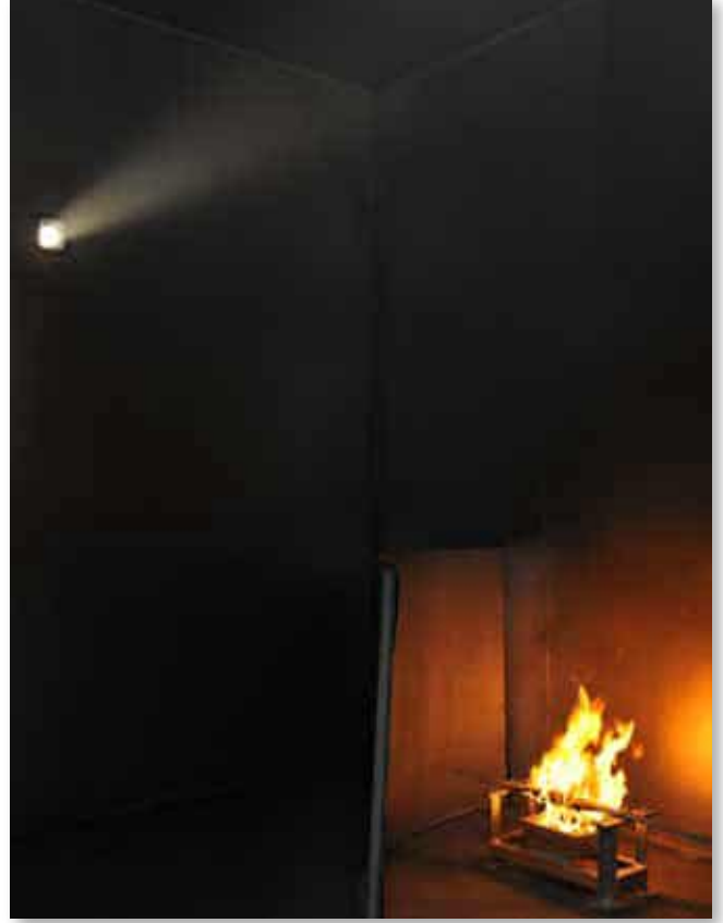
Duman yoğunluğu testindeki bir kablo numunesi.
