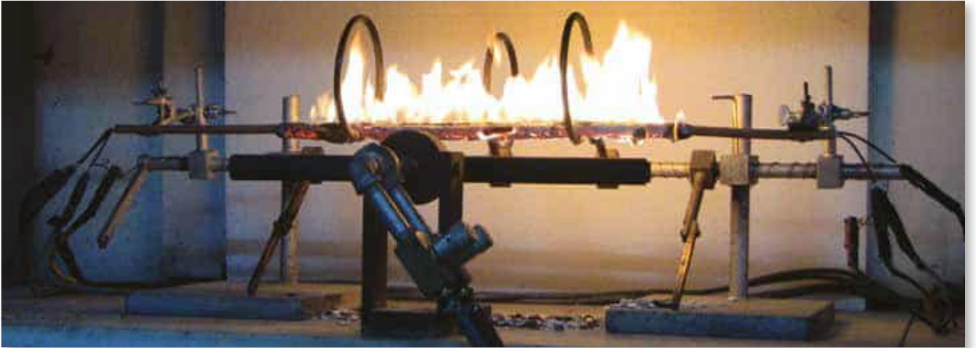
Gerilim altında yanma testindeki bir kablo numunesi.
