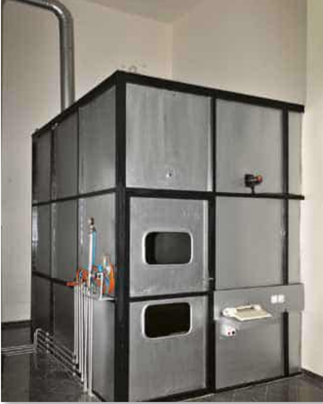
Duman yoğunluğu test kabini.
