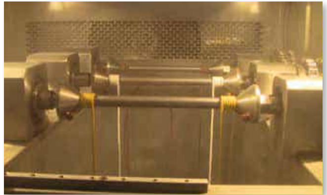
Döngüsel dayanım testindeki kablo numuneleri.
