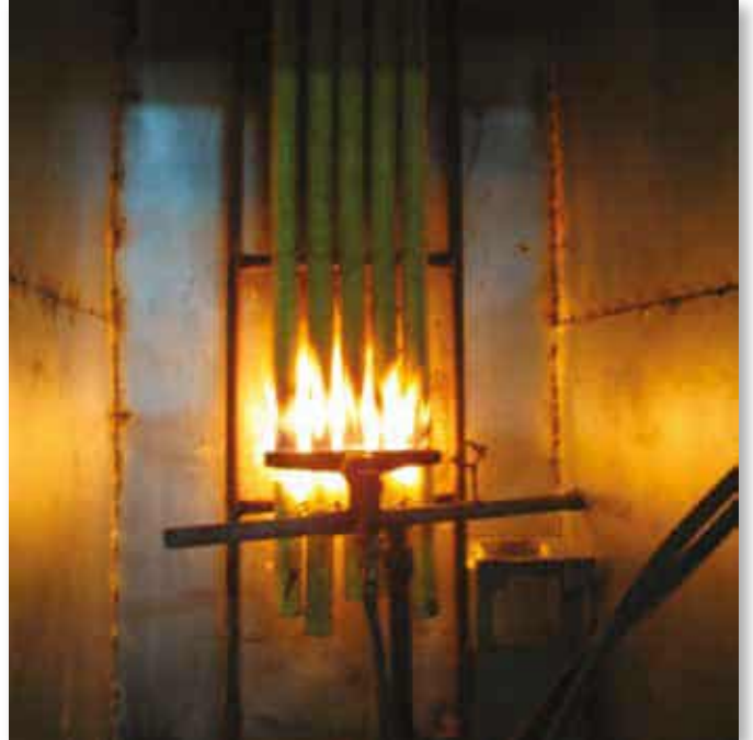
Demetlenmiş kabloların yanması testindeki bir kablo numunesi.
