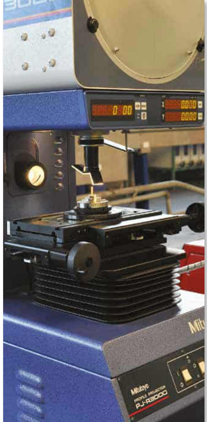
Profil projektör ile geometrik ölçümler yapılır.
