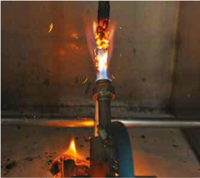
Yanan damlacık testindeki olumsuz bir kablo numunesi.
