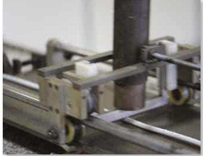
Aşındırma testindeki bir test numunesi.
