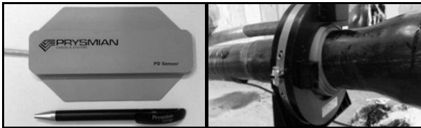
Resim 12 ve 13: Pry-Cam Wings Sensör ve Prysmian Enerji sağlama cihazı (sensör için)
