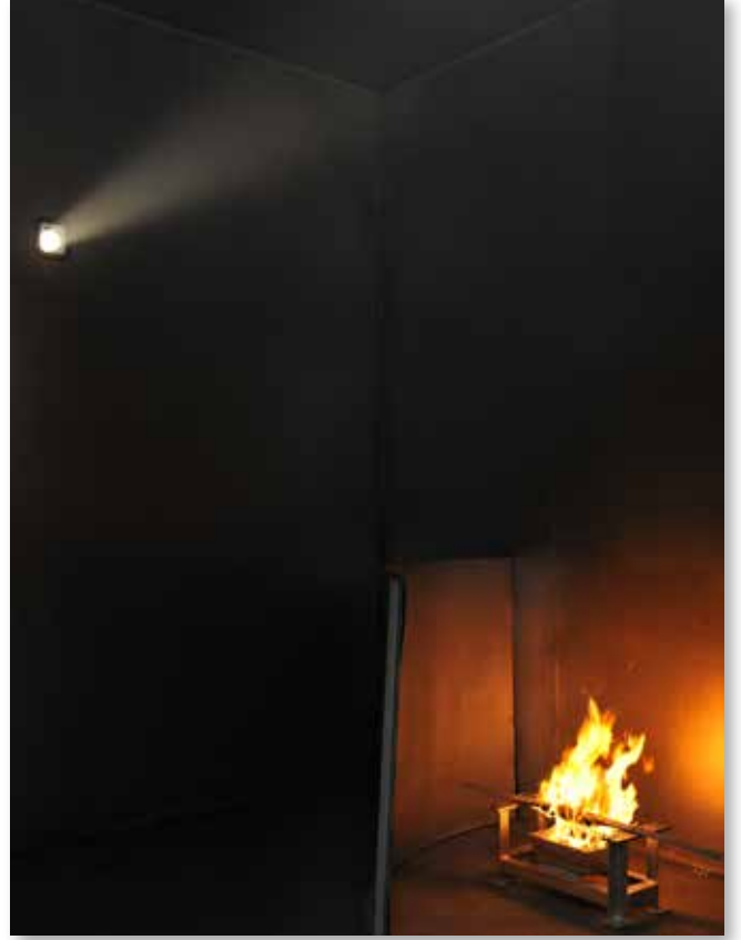
Duman yoğunluğu testindeki bir kablo numunesi.
