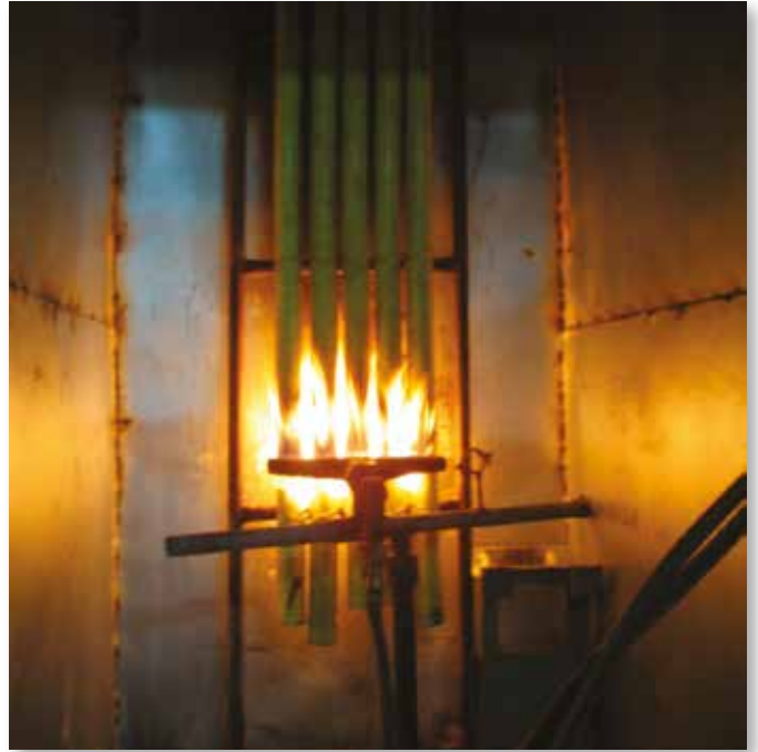
Demetlenmiş kabloların yanması testindeki bir kablo numunesi.
