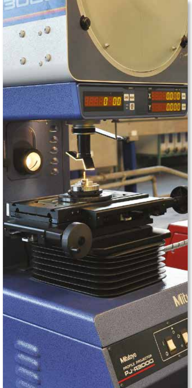
Profil projektör ile geometrik ölçümler yapılır.
