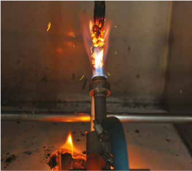
Yanan damlacık testindeki olumsuz bir kablo numunesi.
