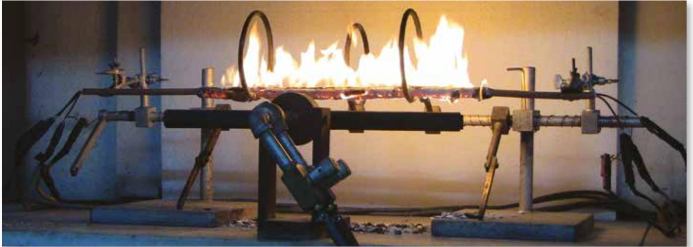
Gerilim altında yanma testindeki bir kablo numunesi.
