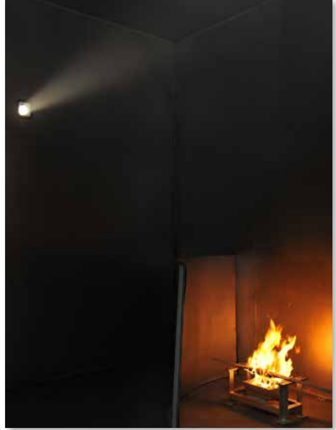
Duman yoğunluğu testindeki bir kablo numunesi.
