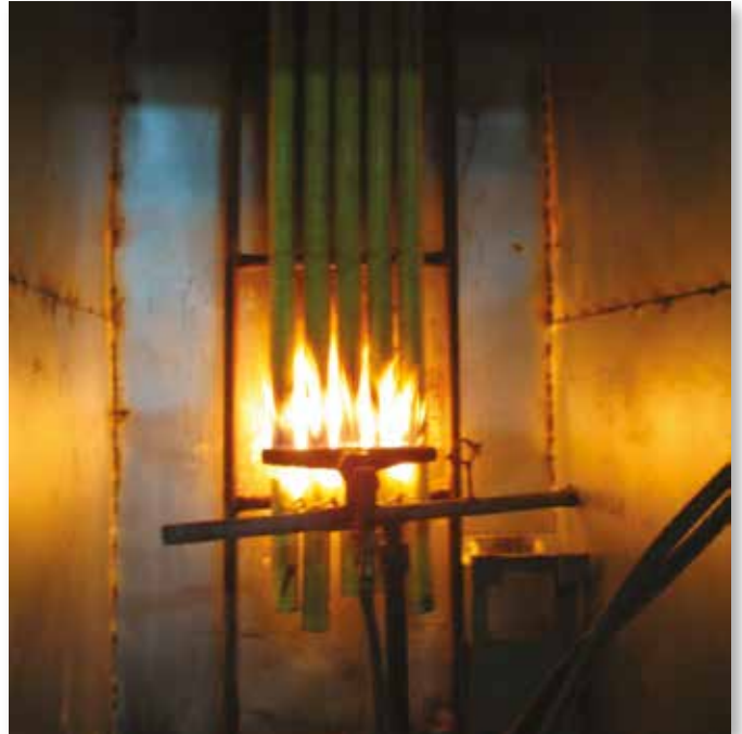
Demetlenmiş kabloların yanması testindeki bir kablo numunesi.
