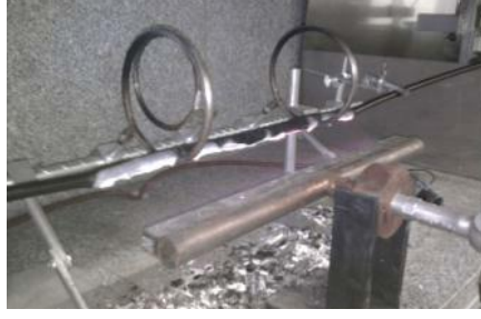
Resim 5: IEC 60331-25 test düzeneği
