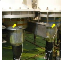
Resim 14: Montajı yapılmış Pry-Cam Wings Sensör
