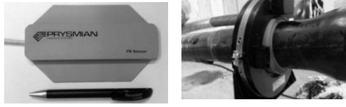
Resim 12 ve 13: Pry-Cam Wings Sensör ve Prysmian Enerji sağlama cihazı (sensör için)
