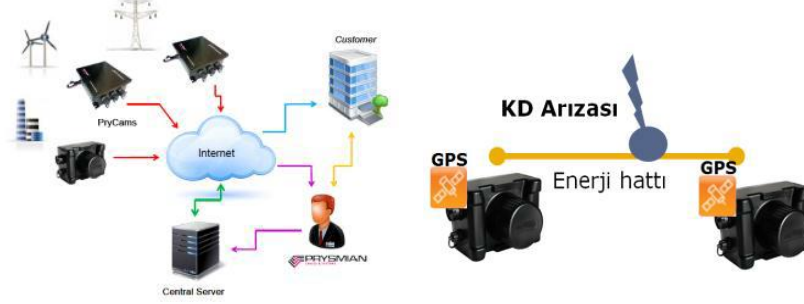
Resim 16 ve 17: Prysmian kısmi deşarj tanı cihazları haberleşme şeması
